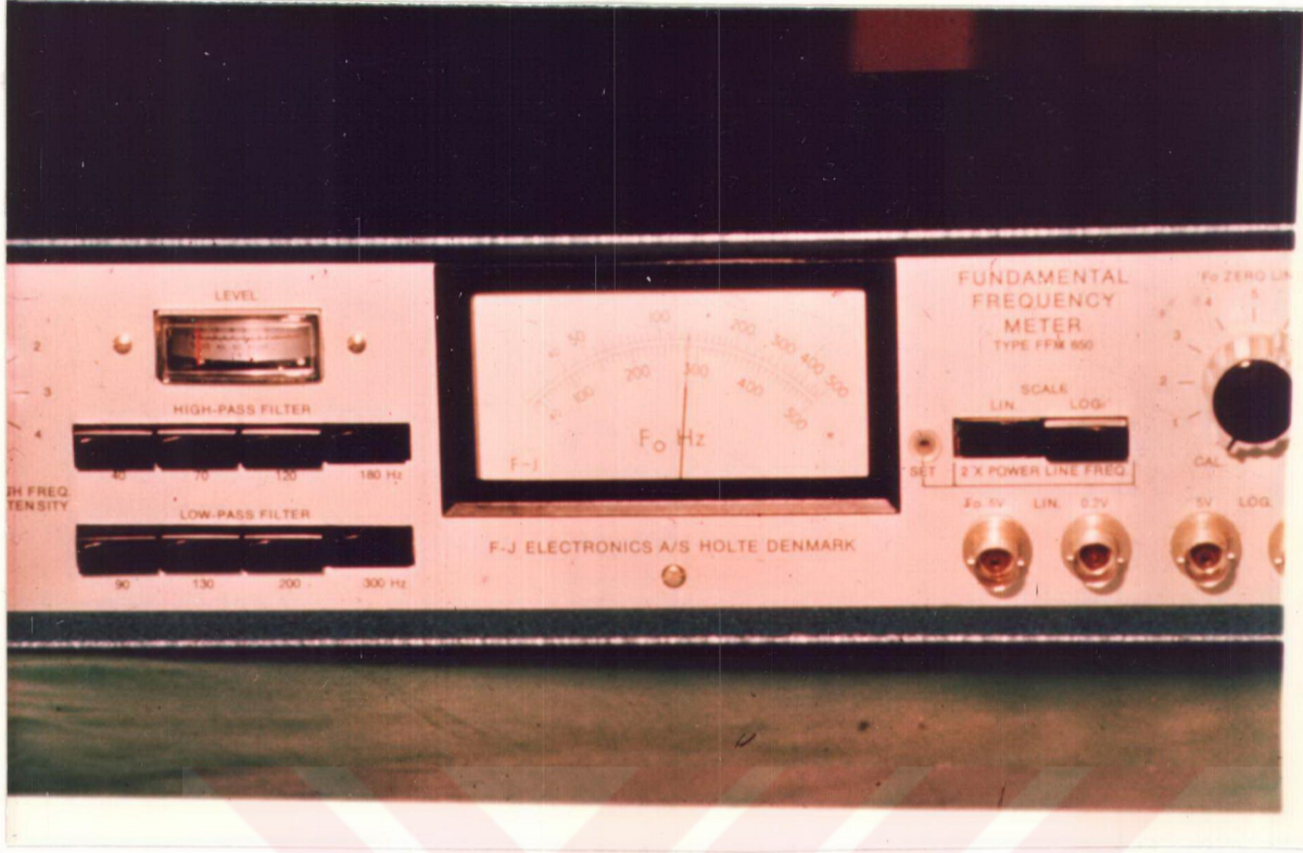
Resim - 1 Fundamental frekansmetre ve göstergeden temel frekansın gözlenmesi.
