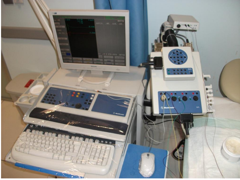
Şekil 34: Elektrofizyolojik değerlendirme için kullanılan EMG cihazı (8-channel Keypoint EMG System; Medtronic, Denmark, 2004)
