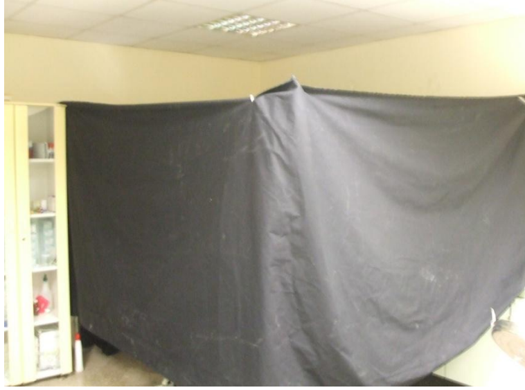
Şekil 30: Işık yansımalarını engellemek için yürüme koridoru ve kamera siyah bir örtü ile çevrildi
