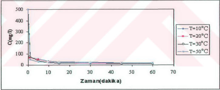
Şekil 4.30. BR 46'nın orijinal kil üzerine adsorpsiyonunda çeşitli sıcaklıklarda başlangıç boyarmadde konsantrasyonunun zamanla değişimi ( C_0= 500 mg/l, m=2 gram orijina pH=4, karıştırma hızı=500 rpm, 0 < dp \leq 45 \mu m).
