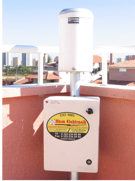
Şekil 3.2.a. Elektronik Yağış Ölçer (Plüviograf)
