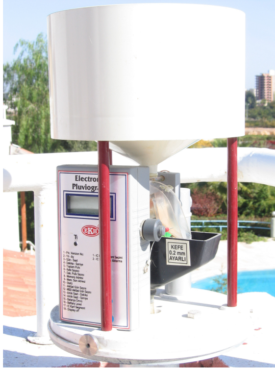
Şekil 3.2.b. Elektronik Yağış Ölçer'in kefi ve veri yükleyicisi.
