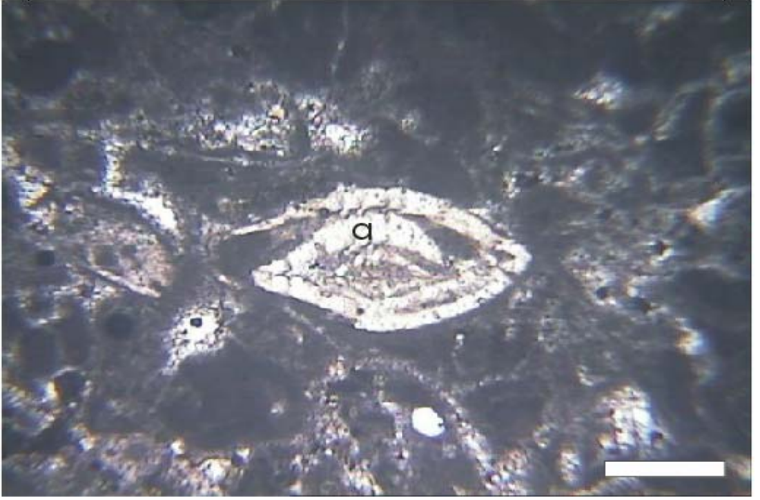
Şekil 4.26. Alt-Orta Miyosen yaşlı Kaplankaya Formasyonu'nun içerisinde görülen Amphistegina sp. (a). Bar ölçek 0,5 mm (Örnek 15).
