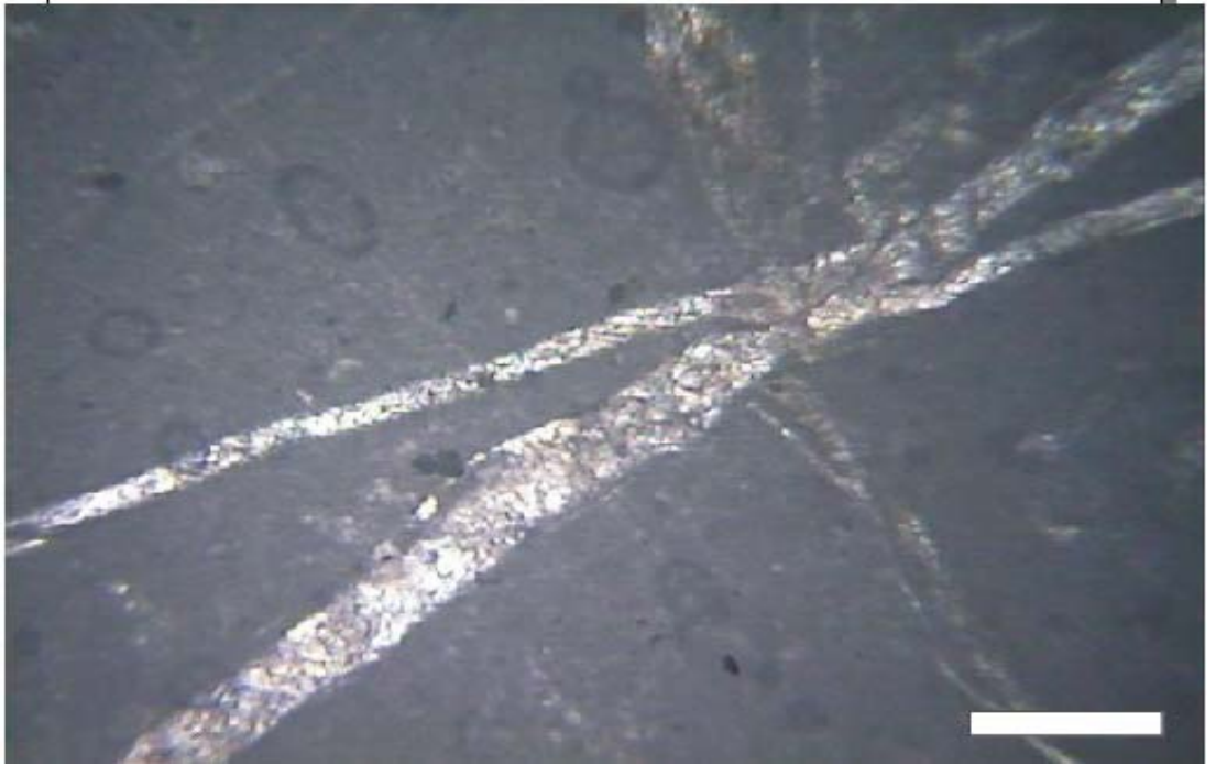
Şekil 4.8. Jura-Senoniyen yaşlı Cehennemdere Formasyonu içindeki mikritik yapıların ve kesme çatlakların görünümü. Bar ölçek 0,5 mm (Örnek 34).
