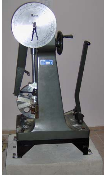
Şekil 3.5. Charpy darbe dayanımı deney cihazı
