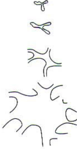
Şekil 2.7. Negatif basınç yüklü, yüksek enerjili kavitasyon kabarcığı
