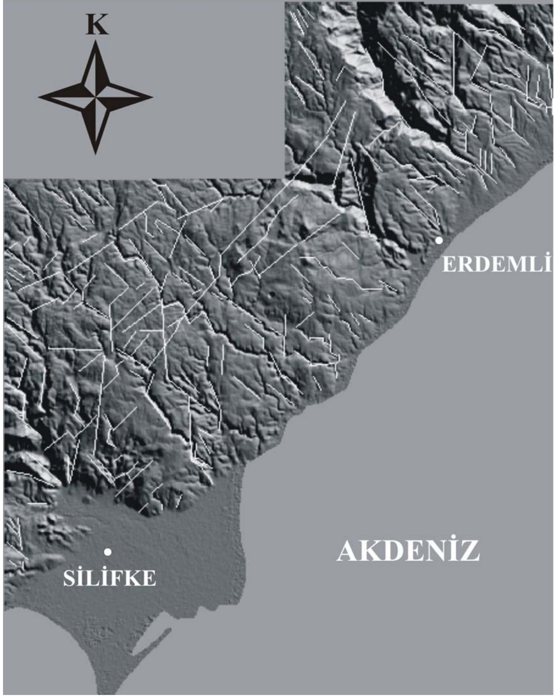
Şekil 4.15. Çalışma alanının rölyef kazandırılmış sayısal yükseklik modeli ve ayırt edilen çizgisellikler.
