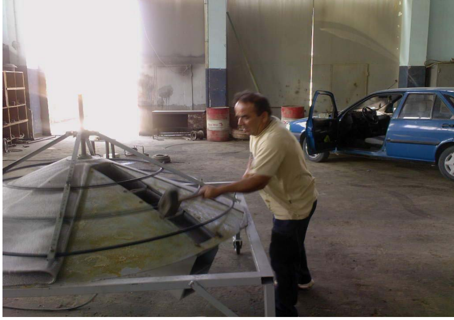
Şekil 5.1. Konideki Bombelik Giderilmeye Çalışılıyor
