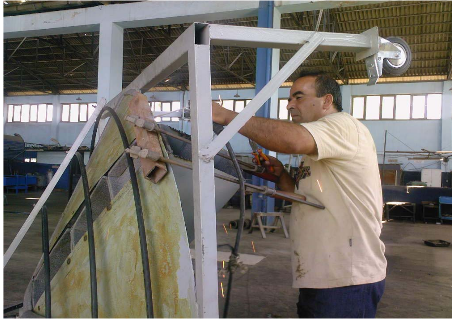
Şekil 5.2. İşkence Yardımıyla Koninin Gerdirilmesi
