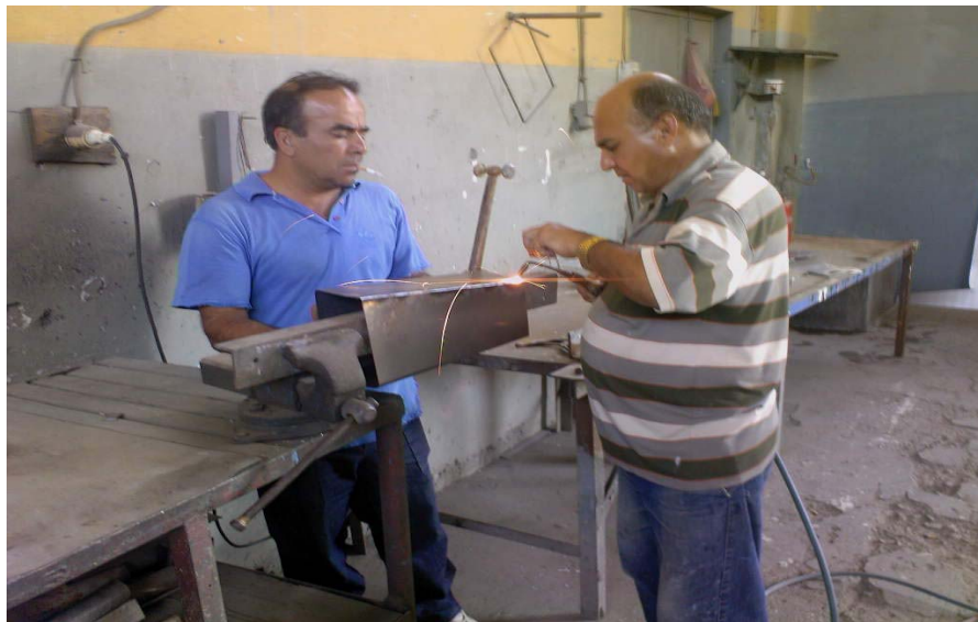
Şekil 3.53. Hazne Yolluklarının İmalatı
