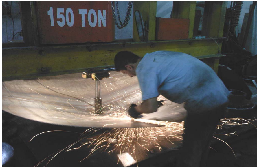
Şekil 3.47. Pürüzsüz Bir Yüzey İçin Koni İç Yüzeyi Taşlanıyor
