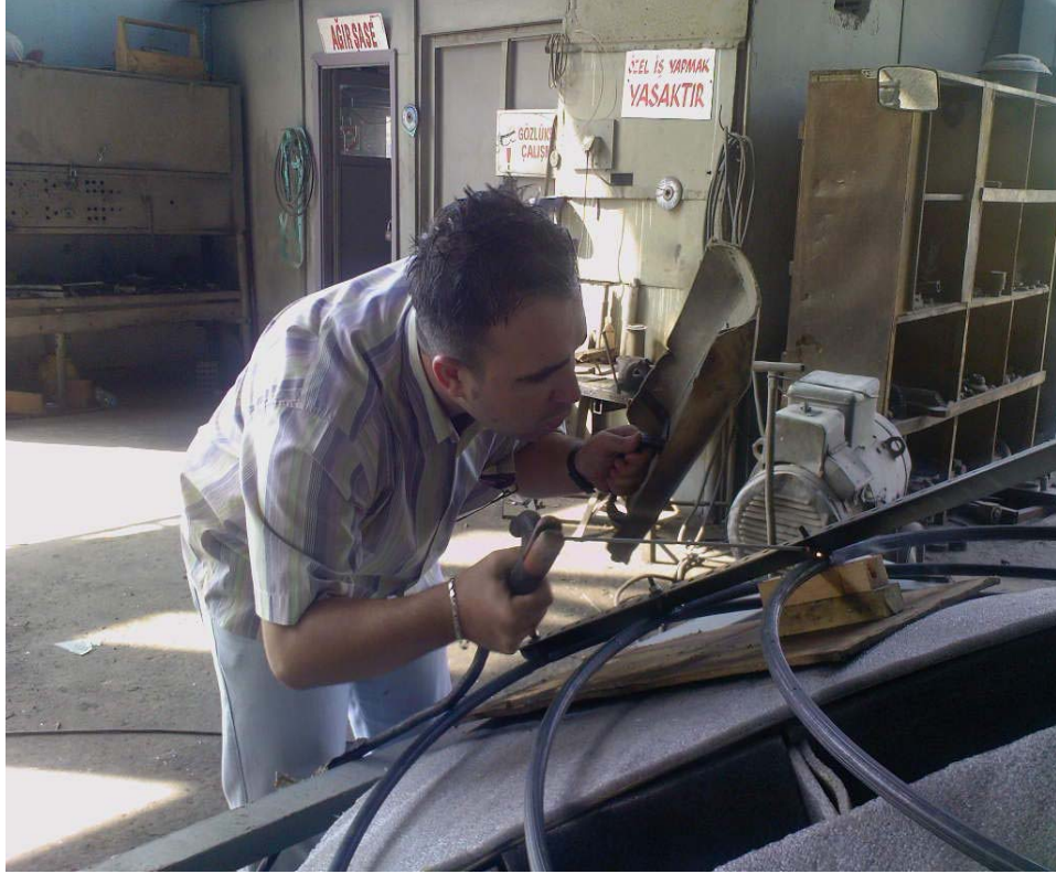
Şekil 3.65. Çemberlerin Elektrik Ark Kaynağı ile Köşebentlere Tutturulması
