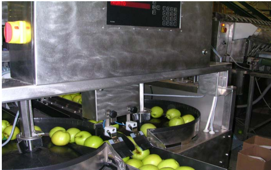
Şekil 2.14. Merkezkaç Kuvvetinden Yararlanarak Tekleştirilen Sistemler [6]
