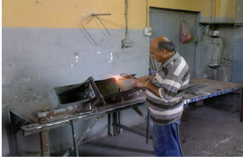
Şekil 3.52. Haznelerin Birbirlerine Oksijen Kaynağı ile Kaynatılması
