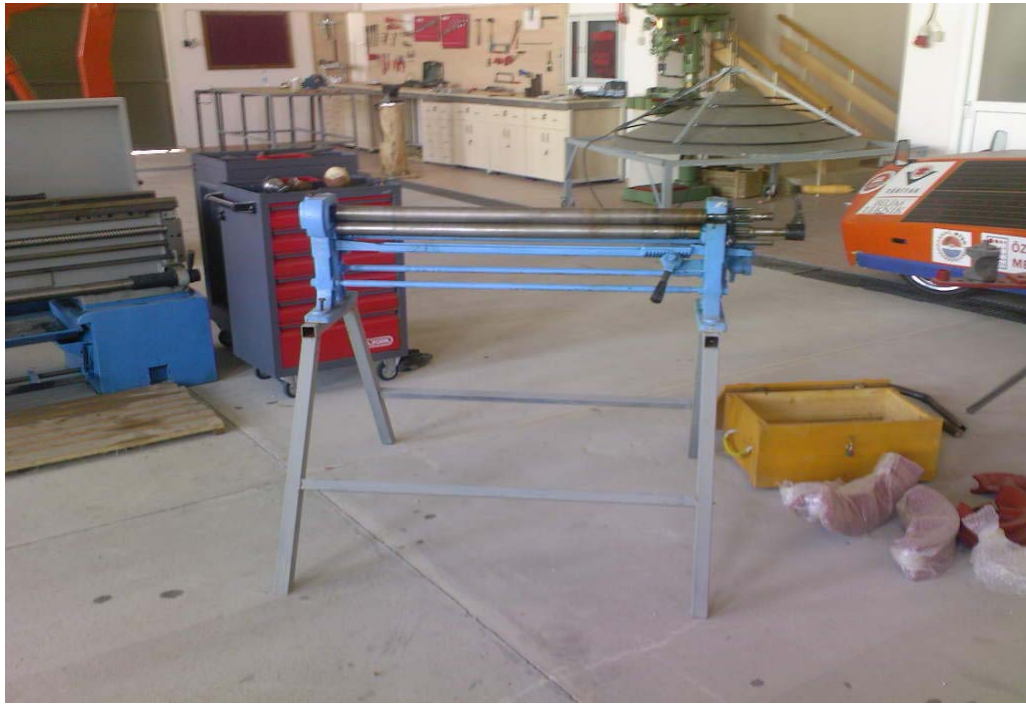
Şekil 3.61. Ön Kıvrırma İşlem Makinesi (Alt Toplar Hareketli)
