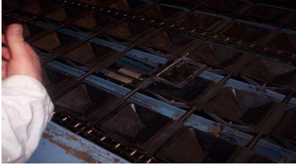
Şekil 2.20. Ağırlığa Göre Tartma Mekanizması ( Unifrutti Mersin Paketleme Tesisi) [9]
