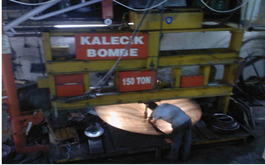
Şekil 3.46. Bası Kuvveti Uygulanırken Sacın Şekil Alması
