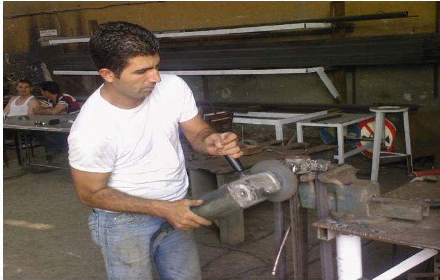
Şekil 3.64. Kaydırıcı Üzerindeki Uzantıların Pahtının Kırılması
