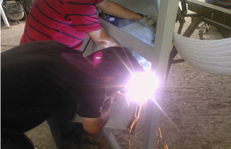
Şekil 3.55. Haznenin Koniye Alttan Kaynak ile Bağlantısı
