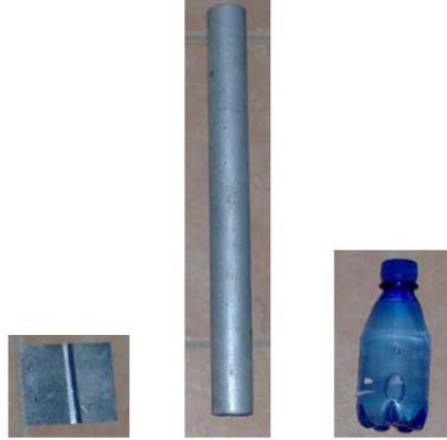
Şekil 4.10. Gerçek toprak deneyinde kullanılan küçük metal plaka, metal boru ve su dolu pet şişe
