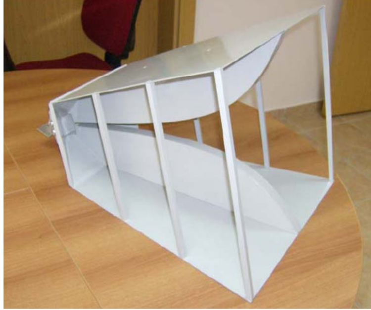
Şekil 3.10. Satın alınan çift sırtlı boynuz antenlerden birinin fotoğrafı
