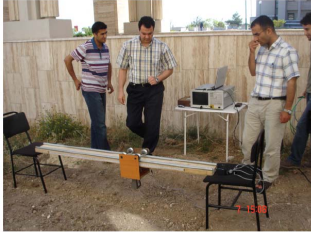
Şekil 4.8. Mersin Üniversitesi Çiftlikköy Yerleşkesi arazisinde gerçekleştirilen B-tarama YNR deneyi
