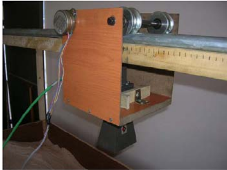
Şekil 4.9. Bilgisayar kontrollü adım motorlu B-tarama düzeni
