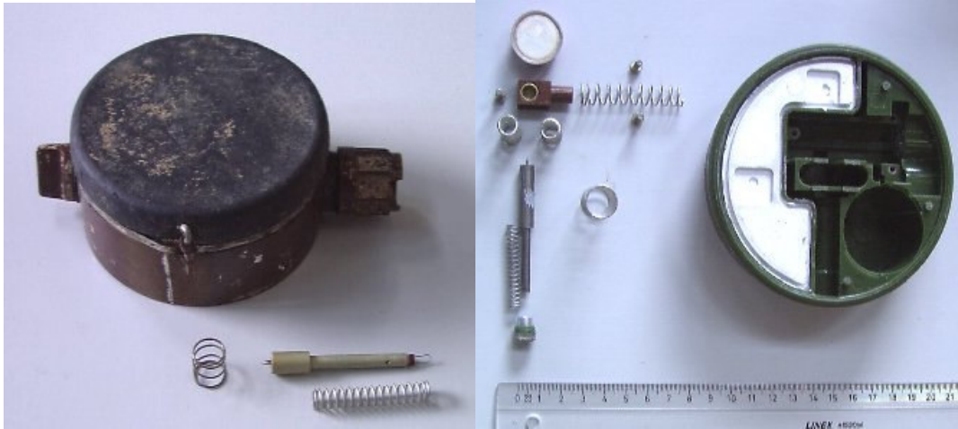
Şekil 2.2. Solda PMN AP mayınının sağda PMN2 AP mayınının metal içerikleri
