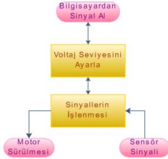
Şekil 3.40. Elektronik kart çalışma prensibi
