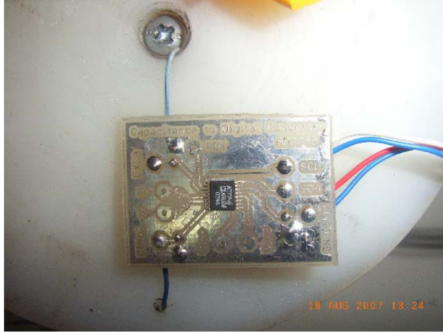
Şekil 4.2. Kapasitanstan Dijitale Dönüştürücüye (CDC) ait devre
