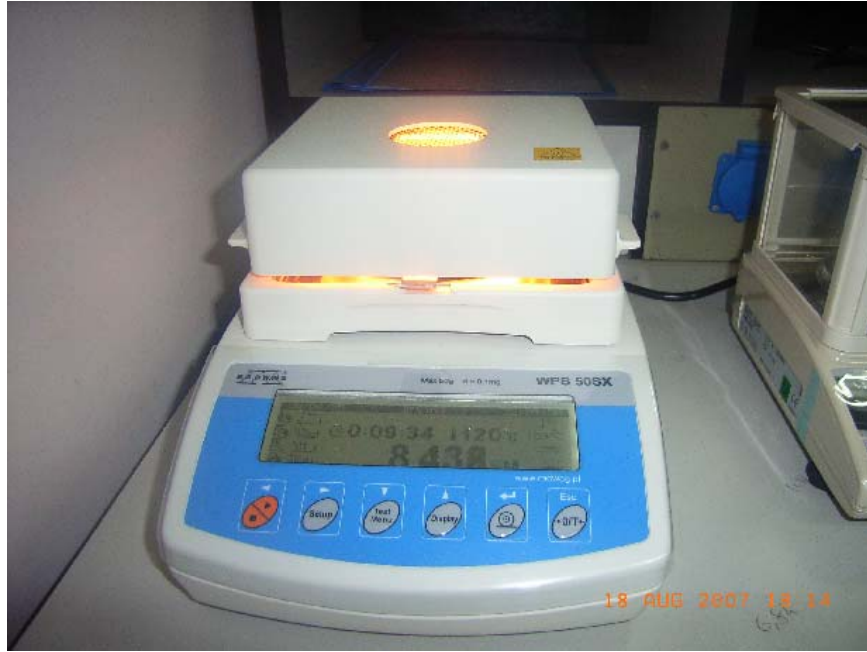
Şekil 3.39. WPS 50SX model nem analiz cihazı
