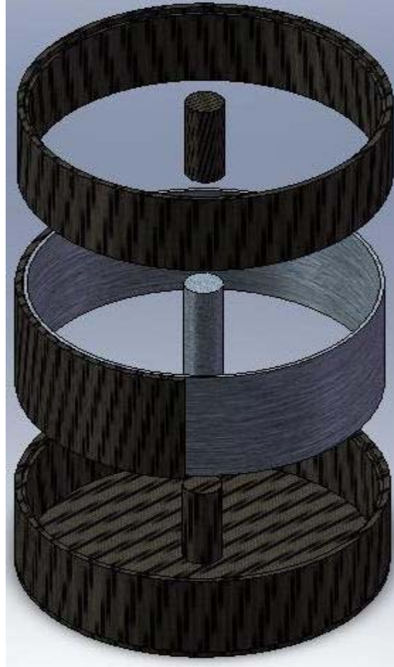
Şekil 3.34. Sıkıştırılmalı nem sensörünün kesitsel parçaları
