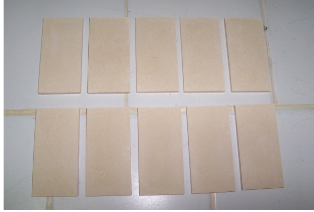
Şekil 5.26. TT örneğine %20 Ukrayna kili karıştırılarak elde edilen tabletler.
