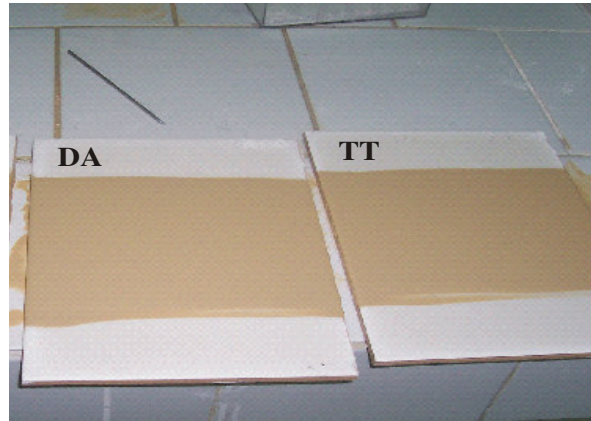
Şekil 5.21. Engoplu duvar karoları üzerine sürülen sır malzemesinin pişirilmeden önceki görünümü (DA:Darvor kaolini ve TT: Kapadokya kaolinitini ).
