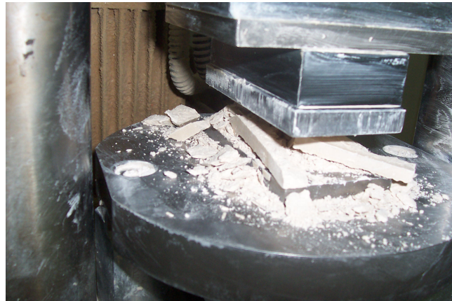
Şekil 5.25. Şekillendirme işleminde tablet haline getirilemeyen TT örneği.
