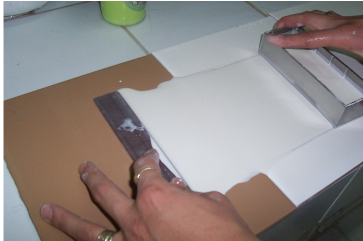
Şekil 2.2. Çekme testinde kullanılan çekme kalıbı ve çekme işlemi.
