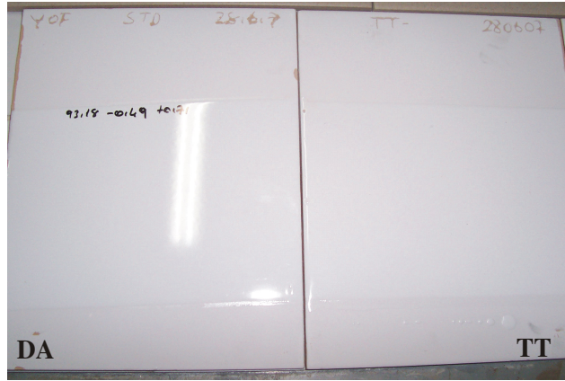
Şekil 5.23. İkinci reçeteye göre sırlanan ürünlerinin 1142 °C pişirildikten sonraki görünüşleri
