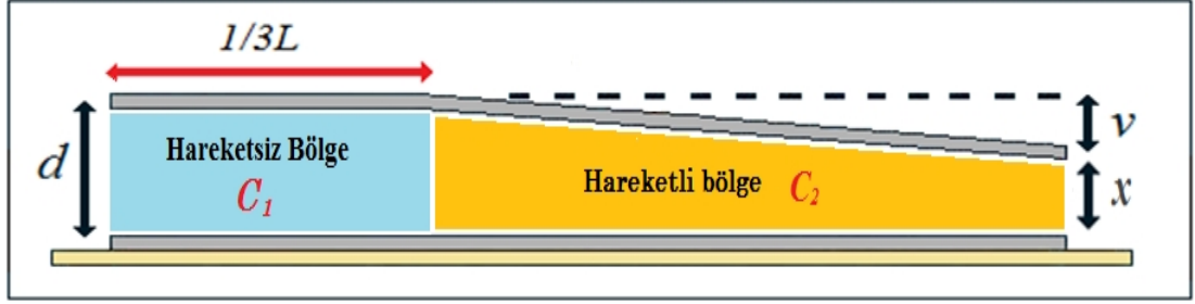
Şekil 3.17. Eyleyici için kapasitans ifadesi
