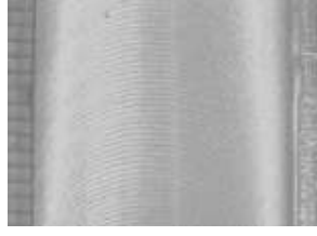
Şekil 3.2. SKK' da kaynak dikişinde oluşan soğan halkaları [16].
