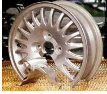
Şekil 3.13. Sürtünme karıştırma kaynağı ile birleştirilen alüminyum alaşımı prototip otomobil jantı [9].
