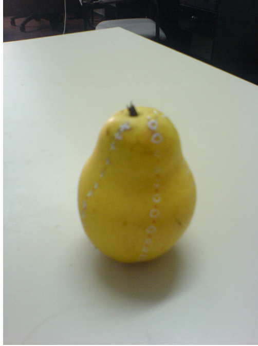
Şekil 3.2. Yüzeyi işaretlenerek tarayıcı mekanizmasına yerleştirilen armut örneğinin tarayıcıda elde edilen görüntüsü ve gerçek görüntüsü.
