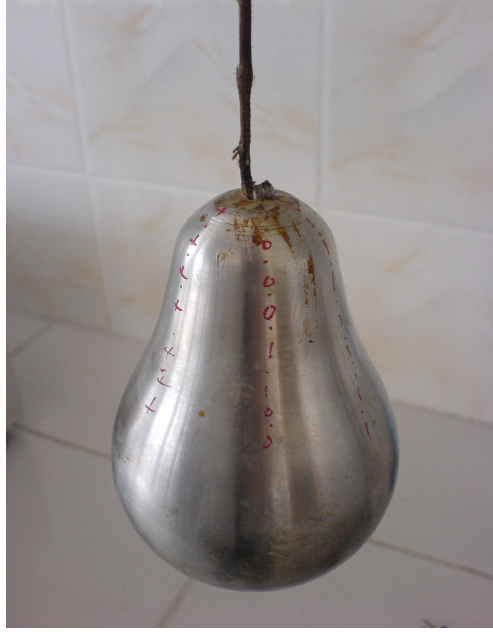
Őekil 4.1. Isı transfer katsayısı ölçümlerinde kullanılan alüminyumdan yapılmıř armut modeli.
