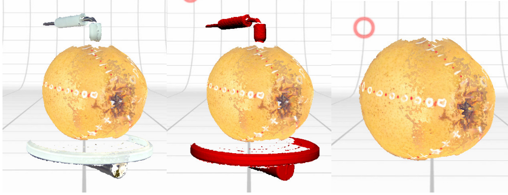
Şekil 3.8. Taranmış görüntüden istenmeyen parçaların temizlenmesi (trimming).
