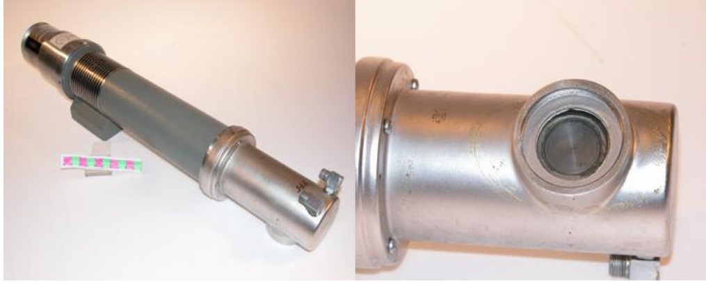
Şekil 3.4. Işınlama için kullanılan X-Işını Tüpü.
