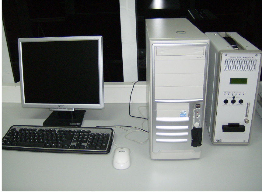
Şekil 3.1. Celal Bayar Üniversitesi Lüminesans Araştırma Laboratuvarında bulunan bilgisayar sistemine bağlı Laboratory Reader-Analyser RA' 94 Termoluminesans Ölçüm Cihazı.
