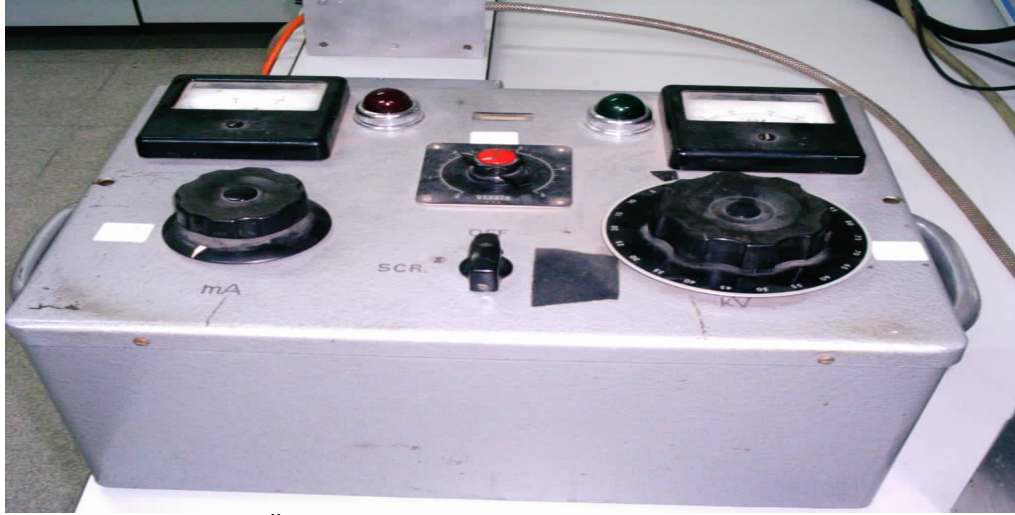
Şekil 3.5 Celal Bayar Üniversitesi Lüminesans Araştırma Laboratuvarında bulunan X-Işını Tüpü kontrol ünitesi.
