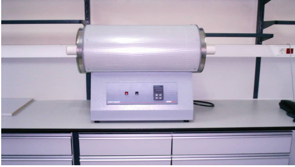
Şekil 3.6. Celal Bayar Üniversitesi Lüminesans Araştırma Laboratuvarında bulunan tavlama işlemi için kullanılan Protern marka boru tipi fırın.
