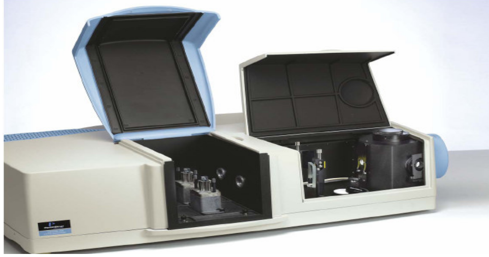
Şekil 3.3. İki farklı örnek odasını da içeren Lambda 950 Spektrofotometresi.
