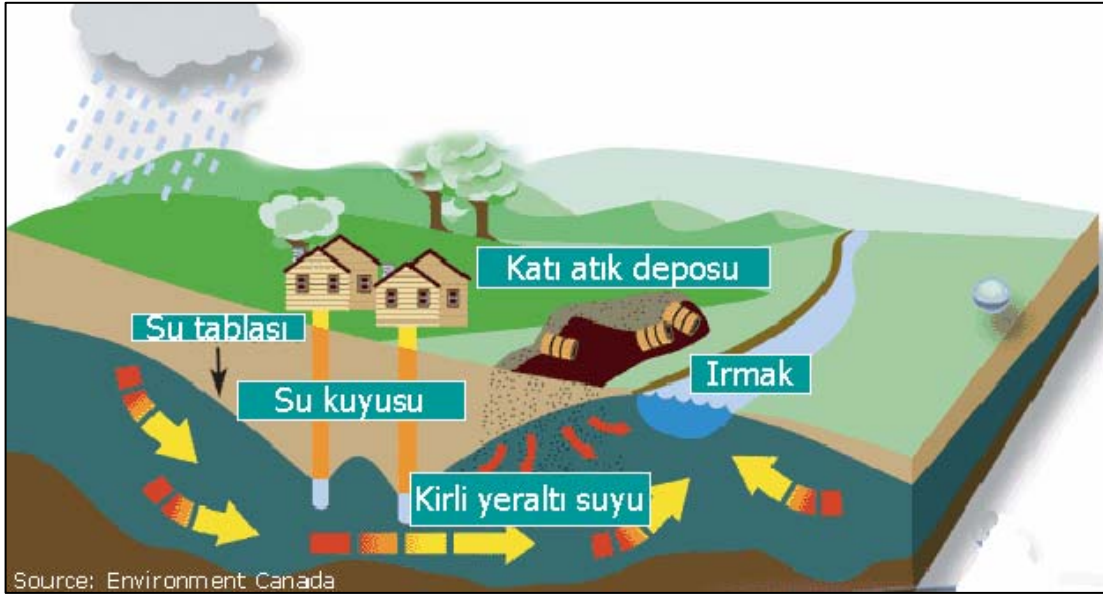
Şekil 2.2. Yeraltı sularının kirlenme mekanizması.
