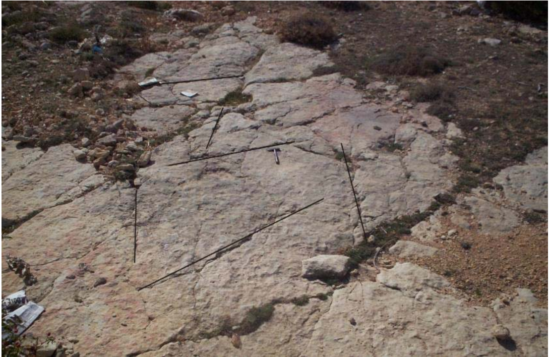
Şekil 6.4. Alt-Üst Miyosen yaşlı Karaisalı kireçtaşında gözlenen kırıklar ve çatlaklar (Güzeloluk 300m batısı).
