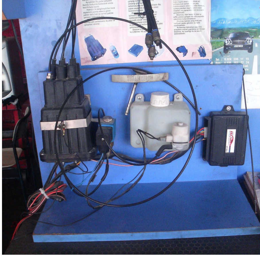
Şekil 3.3. Hidrojen jeneratörü komple görünüşü
