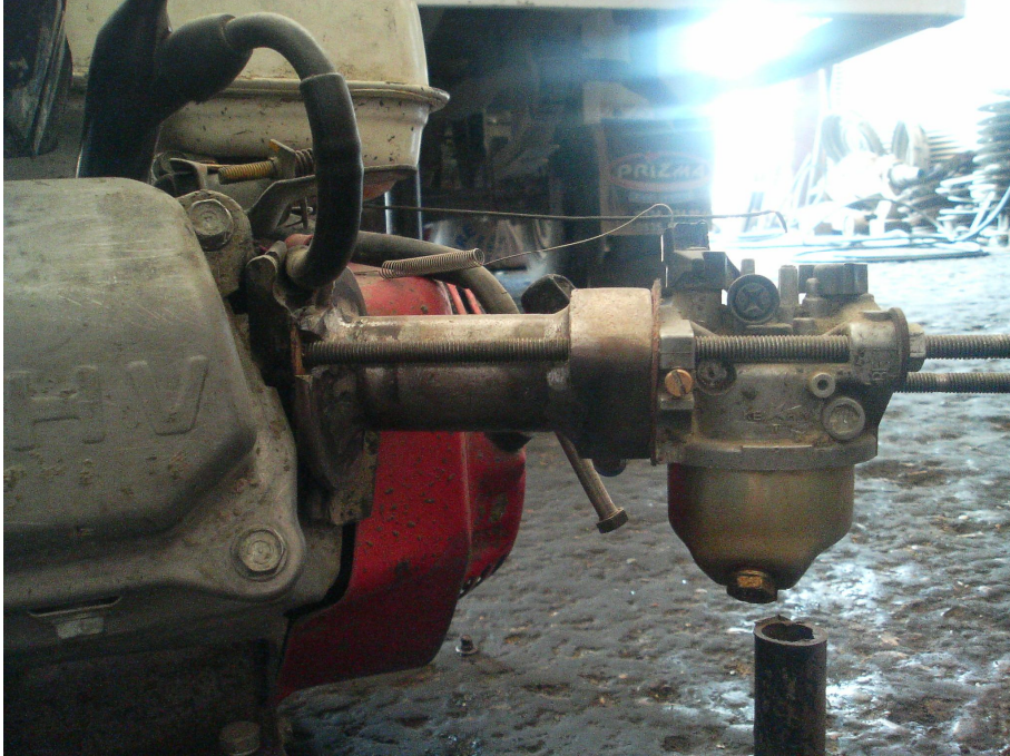
Şekil 3.10. Manifold sisteminin montajlı hali
