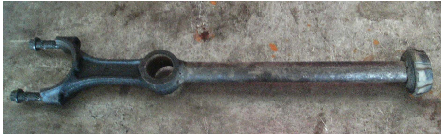
Şekil 3.8. Frenleme sisteminde kullanılan moment kolu
