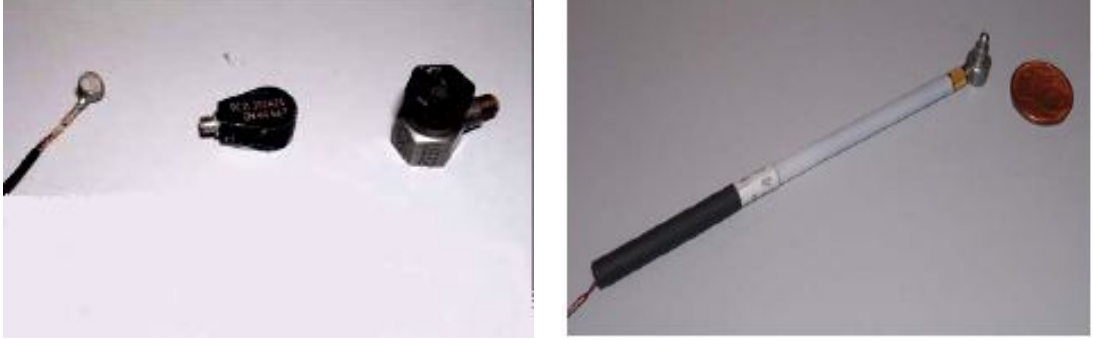
Şekil 3.39. Test için kullanılan hafif ivmeölçerler ve çekiç
