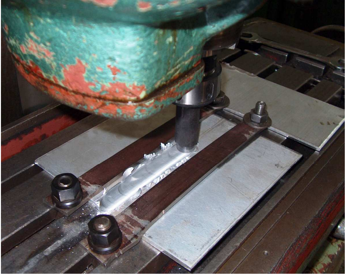
Şekil 3.2. Sürtünme karıştırma kaynak işleminin uygulanışı
