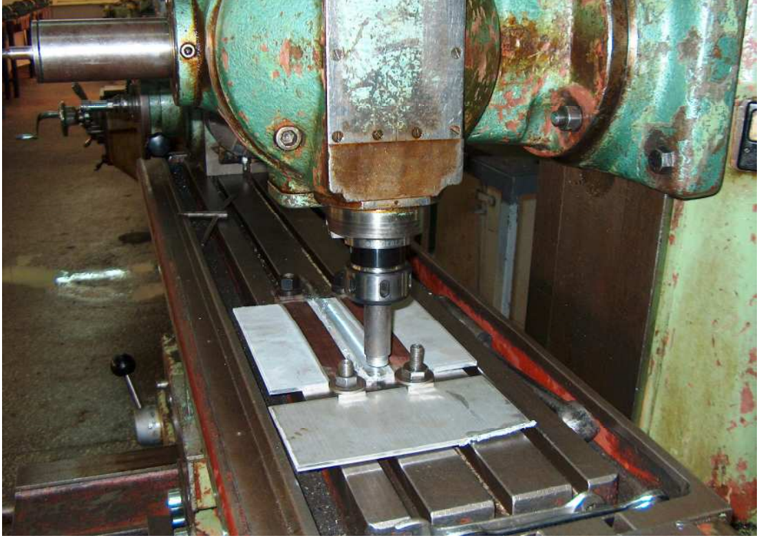
Şekil 3.3. Sürtünme Karıştırma Kaynak işleminde kullanılan dik freze tezgâhı
