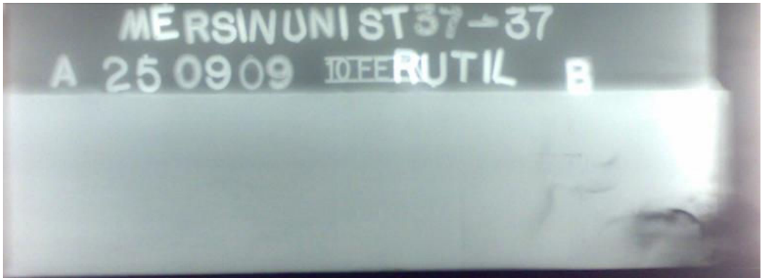
Şekil 4.4. St-37 ile St-37 Rutil Elektrodla Kaynatılmış Kaynaklı Bağlantının Radyografik Filmi
