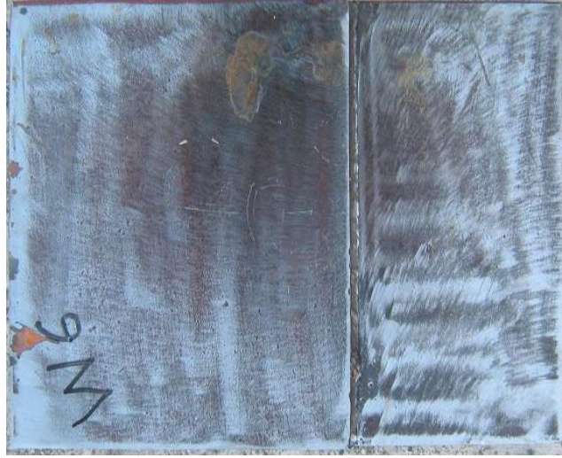
Şekil 3.2 Bindirme Kaynağı Yapılmış Deney Numunesi
