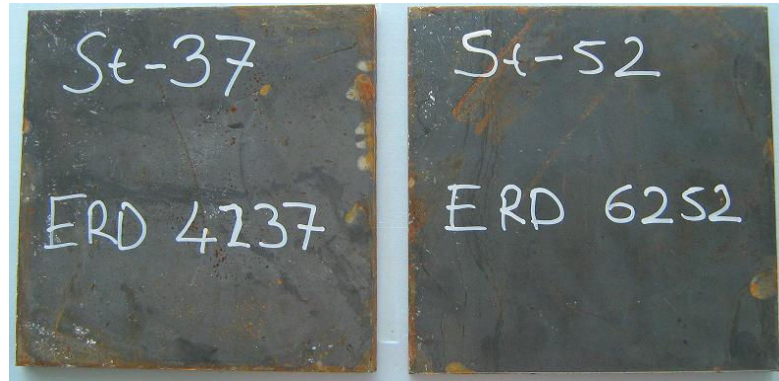
Şekil 3.1. Kaynak Edilecek Numuneler
