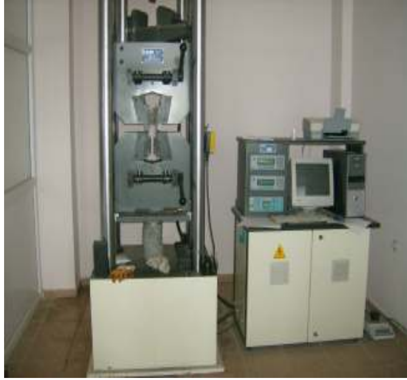
Şekil 3.4. Çekme testinin yapıldığı çekme test cihazı
