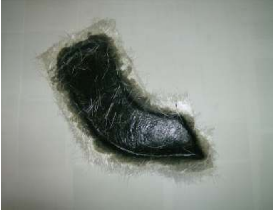
Şekil 3.2. İmal edilen muz lifi destekli kompozit malzeme
