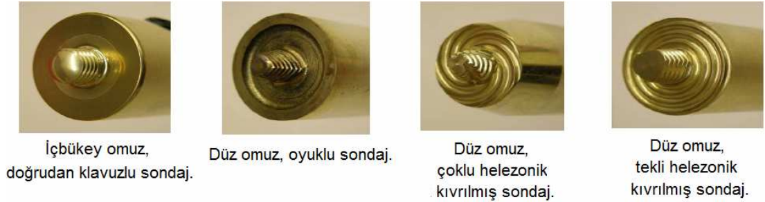
Şekil 2.9. SKNK yönteminde kullanılan çeşitli takım konfigürasyonları [37]
