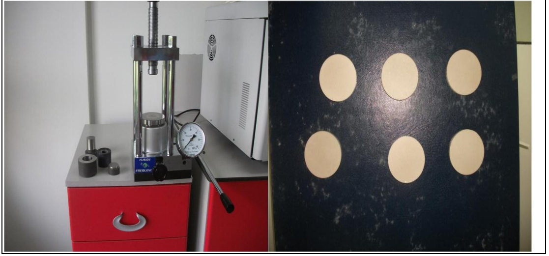
Şekil 3. 3. Pellet basımında kullanılan press cihazı ve analiz için hazırlanmış pelletler.
