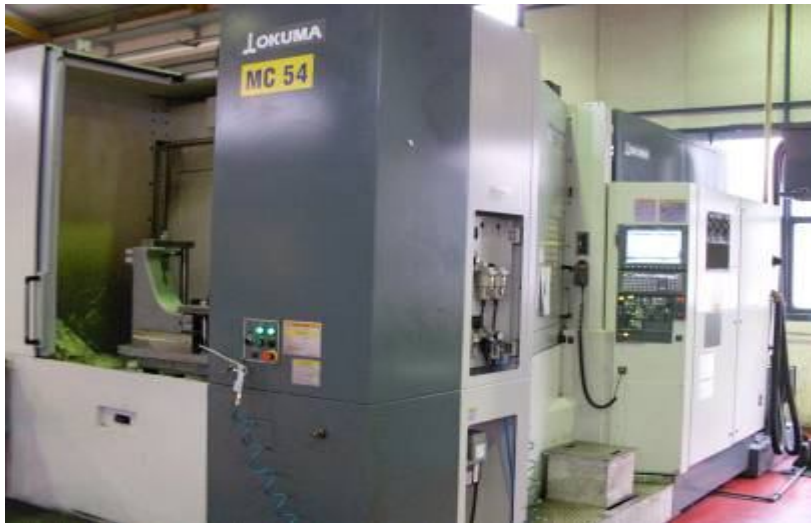
Şekil 3.4 OKUMA MA500-HB Space Center ; Yatay CNC İşleme Merkezi
