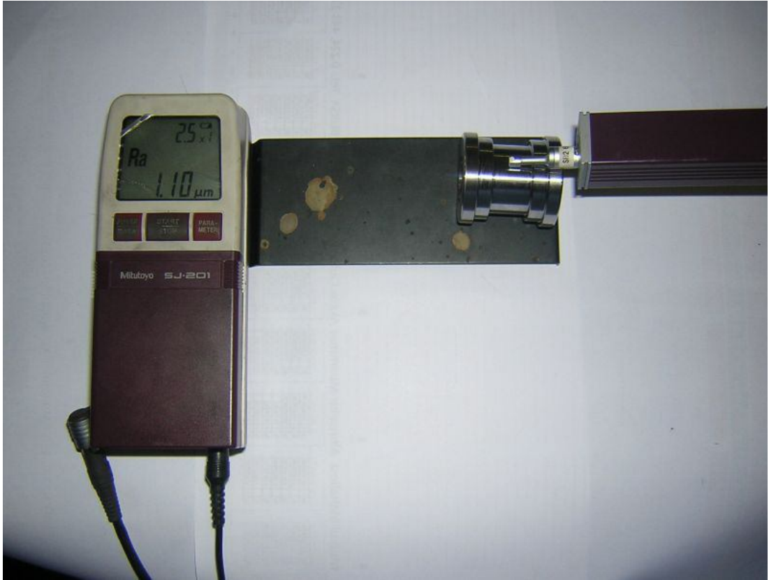
Şekil 3.6. Mitutoyo SJ 201 Yüzey pürüzlülüğü ölçme cihazı
