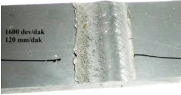
Şekil 4.10. 1600 d/dak. ve 120 mm/dak. takım ilerleme hızı parametreleri ile SKK uygulanan numunenin yüzey görüntüsü
