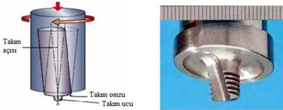
Şekil 2.13. Skew-Stir metodunun çalışma prensibi ve A-Skew ucu [3, 44]
