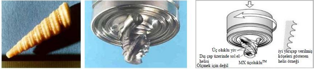
Şekil 2.11. MX Triflute™ pimin esin kaynağı deniz kabuklarıdır. MX Triflute™ serisi pimin resim ve şematik çalışma şekli [3, 44, 45, 47]
