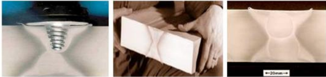
Şekil 2.10. 75 mm kalınlığındaki AA6082T6 alaşımının kaynağında Whorl™ takımının kullanılması, kaynağın bitmiş hali ve kaynak dikişinin görüntüsü [3, 44, 45]
