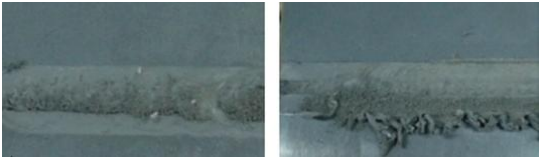
Şekil 4.11. Kötü kaynak dikişine sahip numuneler
