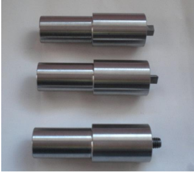
Şekil 3.2. Farklı uç geometrilerine sahip SKK takımları
