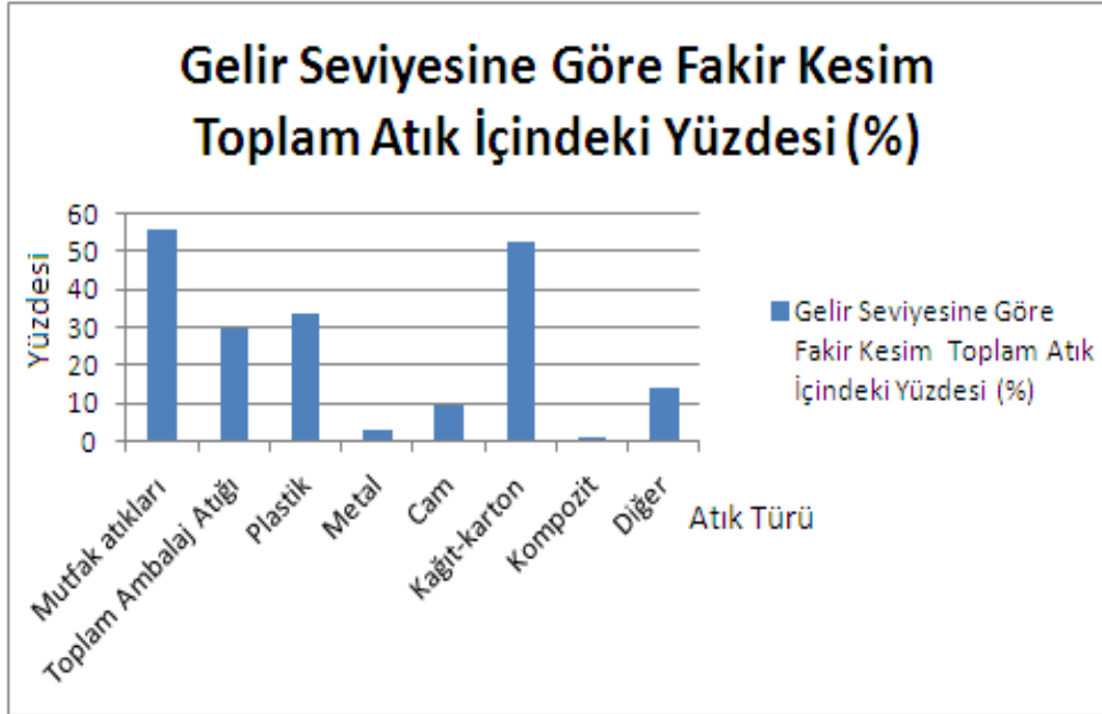
Şekil 4.5: Anamur ilçesindeki gelir düzeyine göre fakir kesimin atık bileşenlerinin, yüzdelerine göre grafiksel gösterimi
