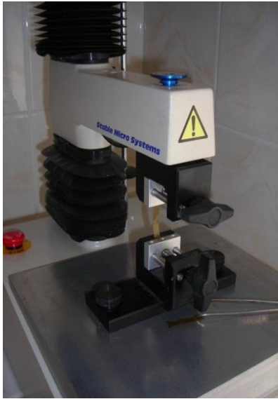
Şekil 3.3. Tekstür cihazı ve cihazın iki çenesi arasına yerleştirilen film
