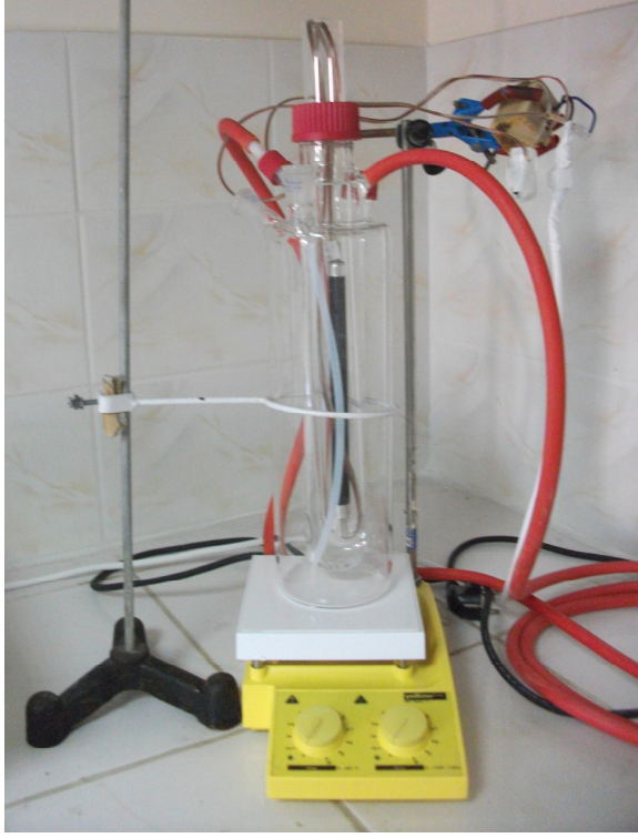
Şekil 3.2. Fotokatalitik oksidasyon (UV/TiO 2 ) deneylerinin gerçekleştirildiği reaktör
