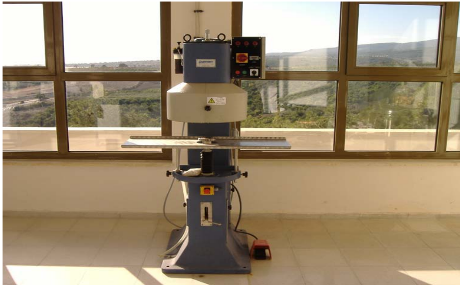
Şekil 3.2. Konserve kutularının hermetik olarak kapatılması için kullanılan kutu kapama makinesi (MAC 230, Umar Makine Sanayi).
