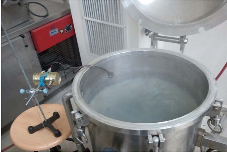
Şekil 3.4. Konservelere yatay olarak ısı işlem uygulanması için oluşturulan deney düzeneği.
