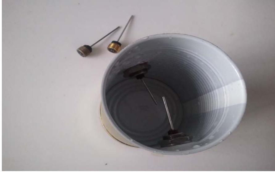
Şekil 3.1. T tipi ısıtma çiftlerinin konserve kutusu içerisine yerleştirilmiş görünümü.
