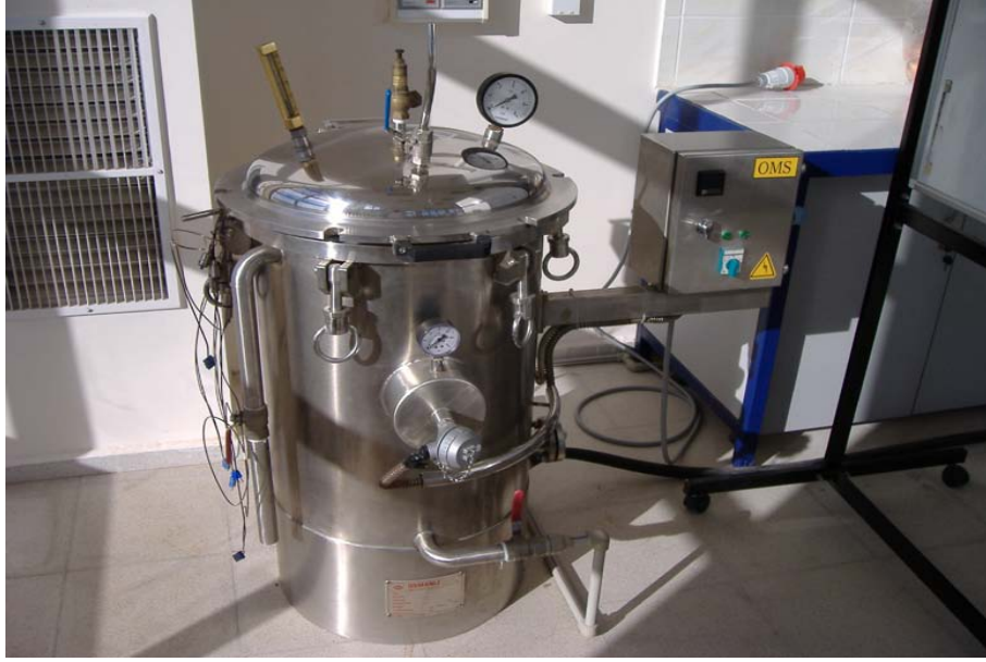
Şekil 3.3. Konservelere uygulanan ısı işlem için kullanılan otoklav sistemi (OMS Lab 20, Osmanlı Makine).
