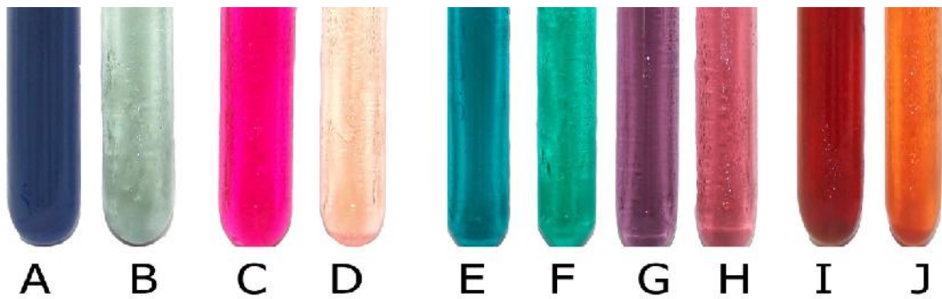
Şekil 4.1: A: Drimaren Blue CL-BR (Kontrol), B: Drimaren Blue CL-BR (10.gün), C: Poly R 478 (Kontrol), D: Poly R 478 (10. gün), E: Methylene Green (Kontrol), F: Methylene Green (10. gün), G: Procion Marina (Kontrol), H: Procion Marina (10. gün), I: Cibacron Ret C2G (Kontrol), J: Cibacron Ret C2G (10. gün).
