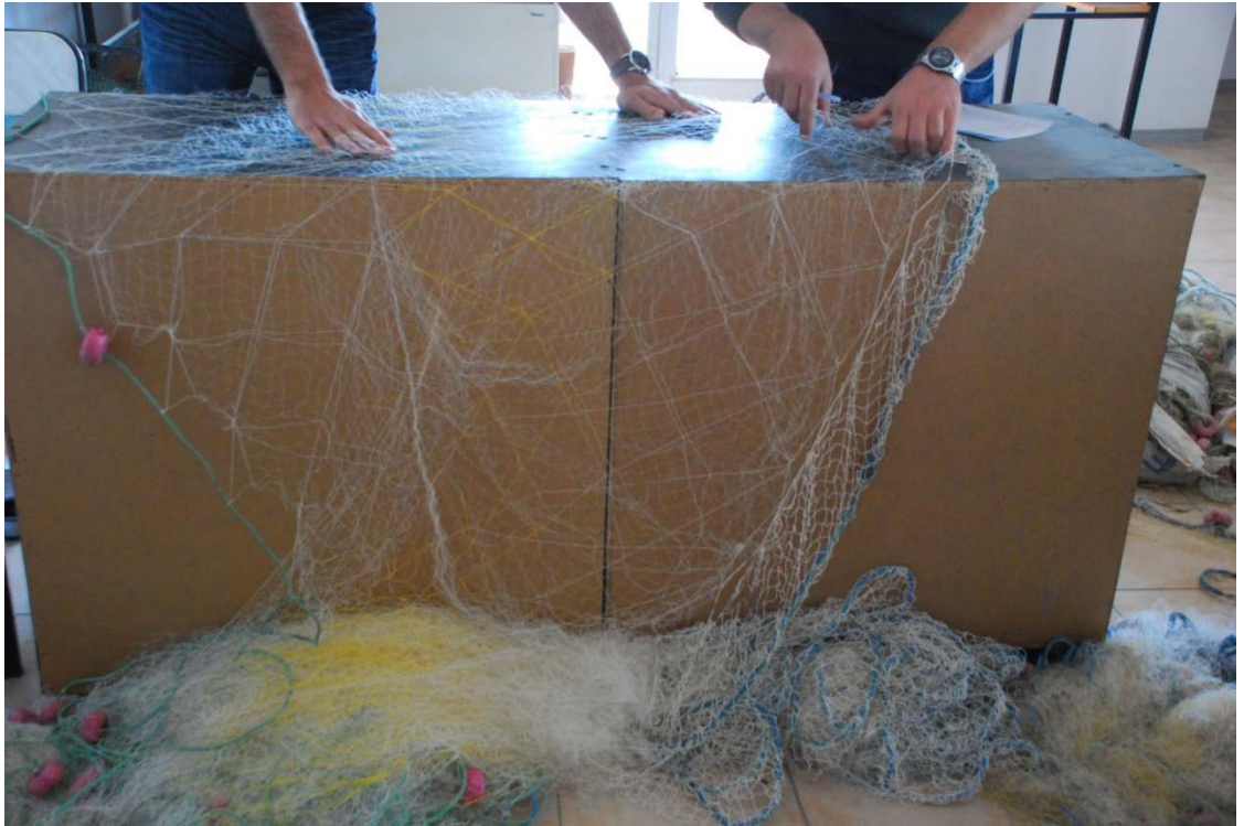
Şekil 4.88. Deneme sonunda ağda meydana gelen yırtıkların sayılması
