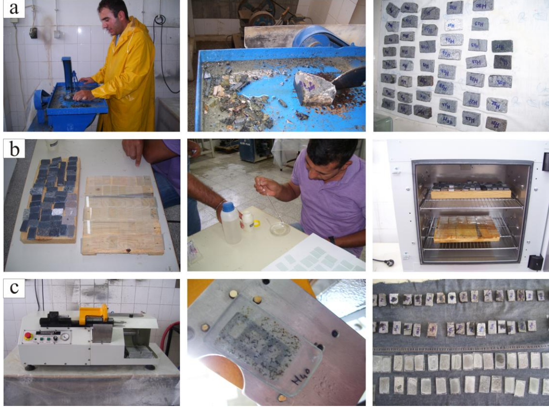
Şekil 3.1. İnce kesit yapım aşamaları; a) kesme, b) yapıştırma, c) inceltme.
