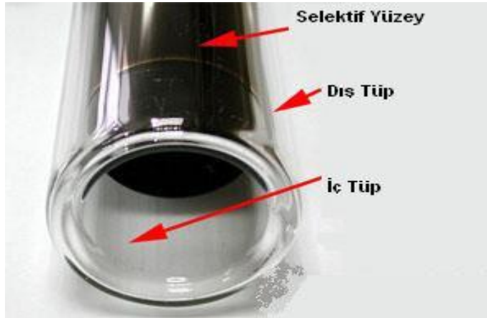
Şekil 2.13. Vakumlu kolektörün görünüş ve kısımları [15]
