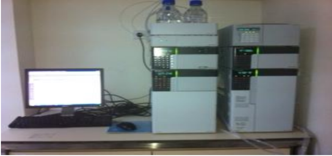
Şekil 3.3. HPLC (yüksek performanslı sıvı kromatografisi) sistemi
