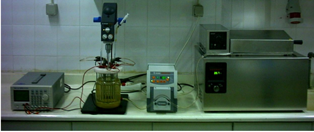
Şekil 3.2. Kesikli elektrokimyasal reaktör sistemi
