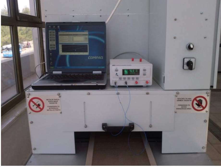
Şekil 4.5. RF kurutma sırasında dilim sıcaklıklarını ölçmek için kullanılan fiber optik sıcaklık ölçüm düzeneği
