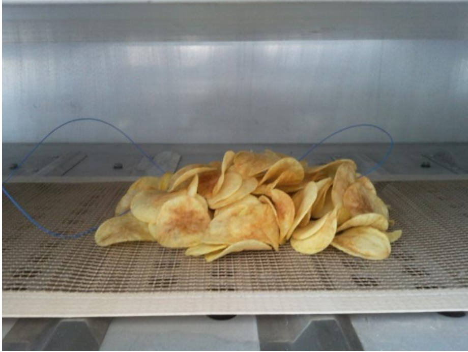
Şekil 4.6. Yığın içerisinde yerleştirilen fiber optik sıcaklık probunu
