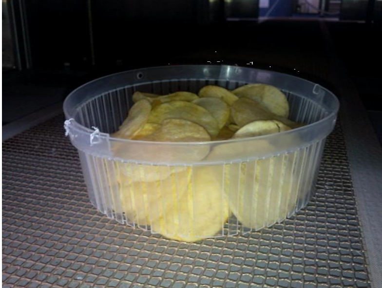
Şekil 4.3. Radyo frekansı ile homojen kurutmanın sağlanabilmesi için kullanılan plastik kase
