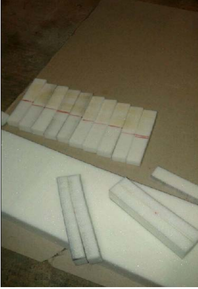
Şekil 3. 3. Yapıştırıcı uygulan süngerler
