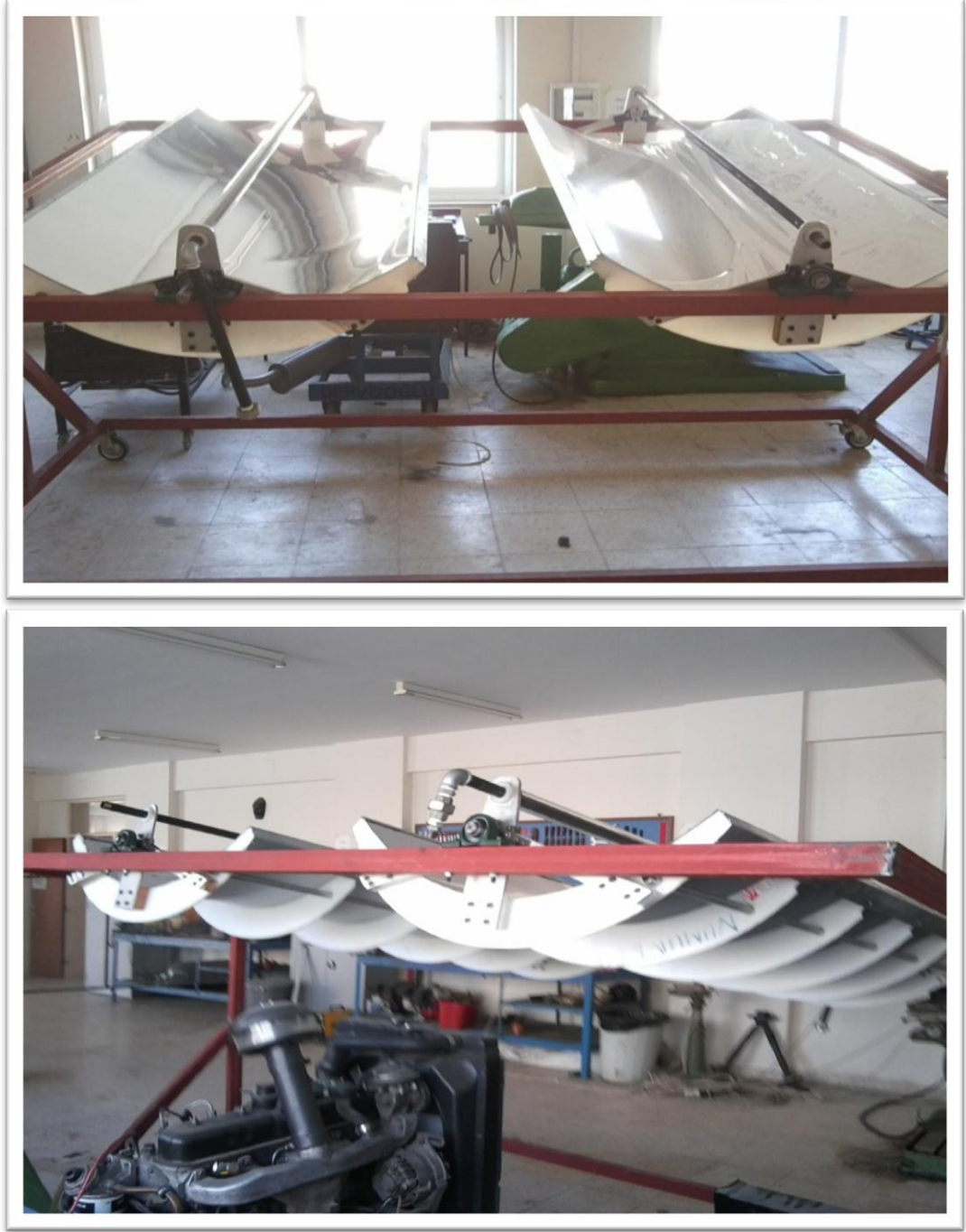
Şekil 3.35. Taşıyıcı sistem üzerine yerleştirilen parabolik oluk kollektörlerin ön ve arka görünüşü
