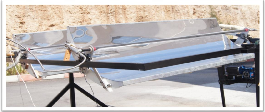
Şekil 3.30. İmalatı yapılan parabolik oluk tipi güneş kollektörünün görünüşü
