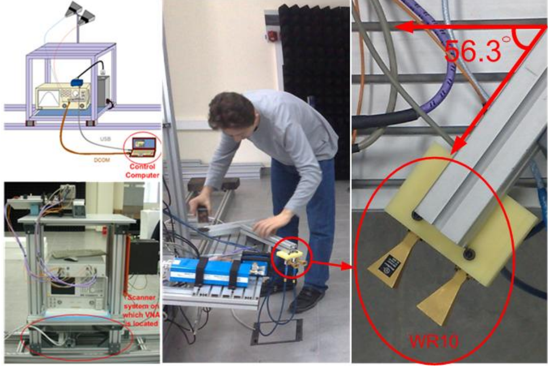
Şekil 4. 13. Milimetre dalga radarın ölçüm düzeneği (Sol). Antenlerin eğik açılarının ayarlanması (Orta), Boynuz antenler (sağ)
