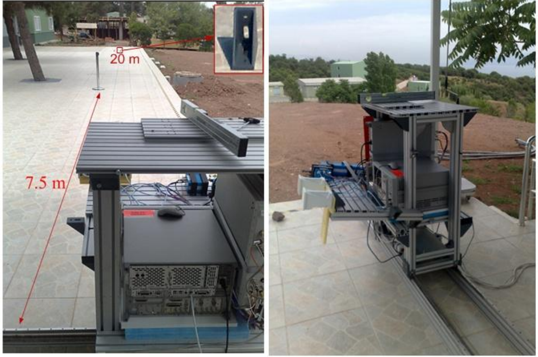
Şekil 4. 19. X-Bant dış ortam YT-SAR uygulaması; 7 cm çapında silindirik metal hedef ve 2 adet 8 cm boyunda metal köşebent ve YT-SAR platformu
