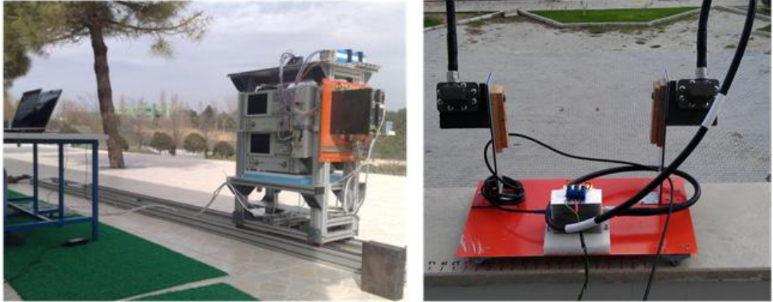
Şekil 3. 6. Tezde kullanılan hareketli platformlar; (a) Step motor kontrollü, dişli hareket düzeneğine sahip 1 mm hassasiyetli veri toplama kabiliyetinde olan YT-SAR platformu, (b) Balkon ve duvar üstü manüel kontrol ettirilebilir YT-SAR platformu
