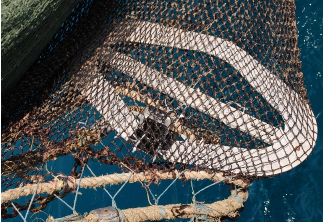
Şekil 3.11. Kurşun yakaya alüminyum çerçeveyle sabitlenmiş GoPro Hero 2.
