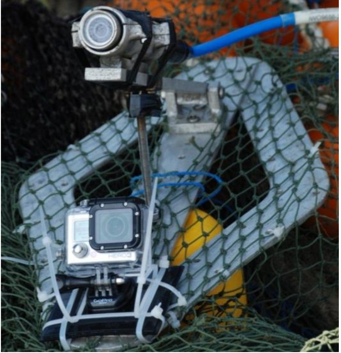
Şekil 3.15. Mantar yakaya alüminyum çerçeveyle sabitlenmiş Bowtech LCC 600 ve GoPro Hero 3 Black Edition.
