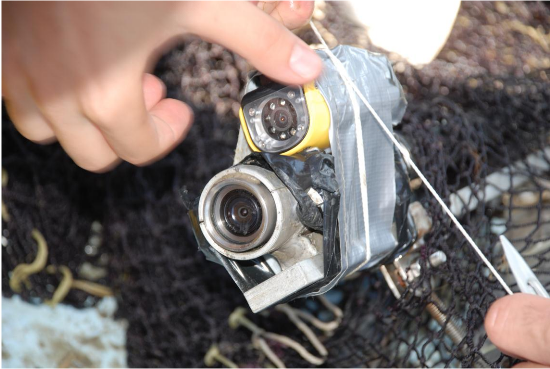
Şekil 3.14. Alüminyum çerçeveye sabitlenmiş Bowtech LCC 600 ve RD32.
