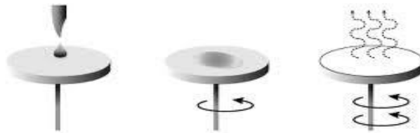
Şekil 2.6. Döndürme ile kaplama yönteminin gösterimi
