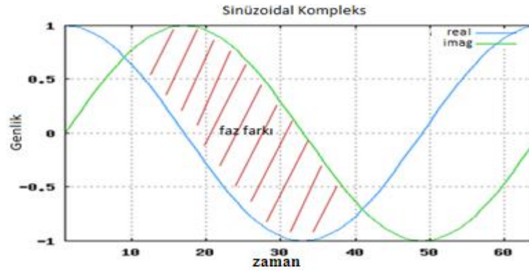
Şekil 3.10. Empedans spektroskopisinde faz farkını gösteren sinüzoidal akımlar
