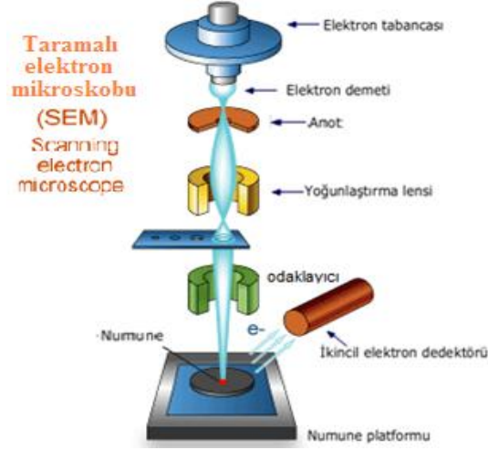
Şekil 3.2. SEM cihazının şematik yapısı [49].
