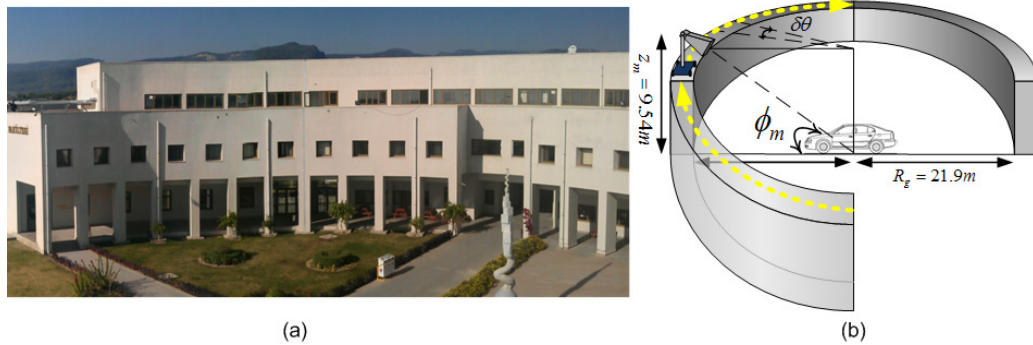
Şekil 4.34. Yer tabanlı dairesel-SAR görüntülemenin deneysel geometrisi. (a) 270^\circ yay yapısına sahip bir bina (b) binanın dairesel-SAR ölçümleri için kullanımının şematik diyagramı.
