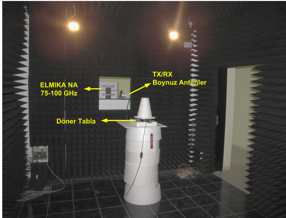
Şekil 3.1. TÜBİTAK-MAM'daki yansımatsız oda. Oda duvarları ve tavanı soğurucu madde ile kaplanmıştır; tabana da kısmen ek soğurucu konulabilmektedir. Yarı-monostatik antenler ile VNA odaya bitişik küçük bir hazneye yerleştirilmişlerdir.
