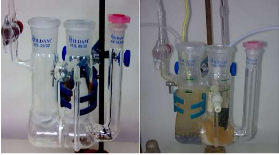
Şekil 3.2. Elektrokimyasal arıtımın gerçekleştirildiği sabit yataklı cam reaktör
