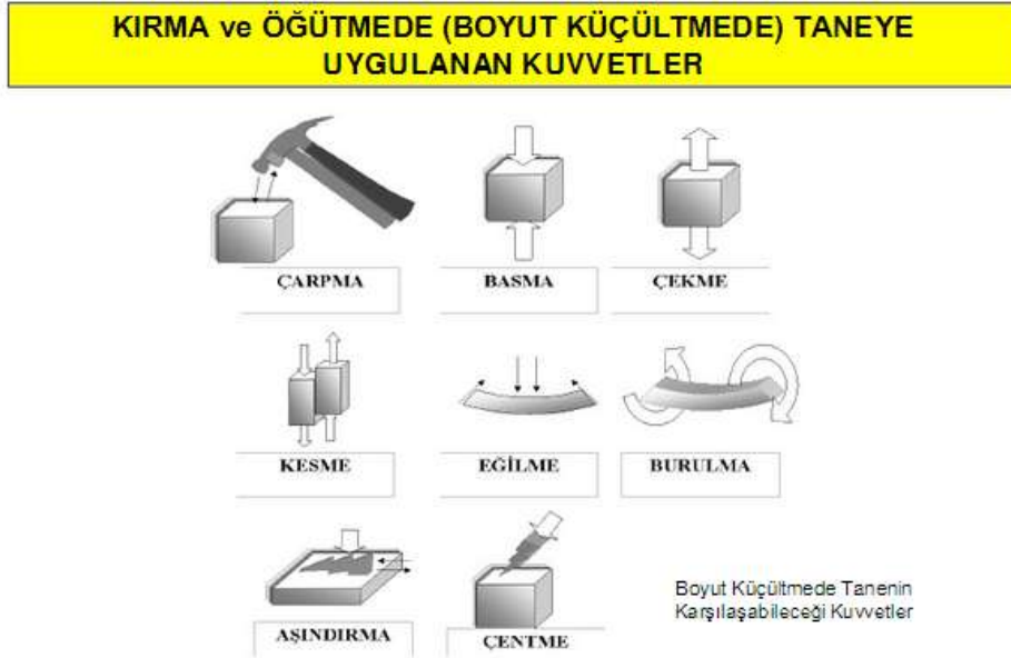
Şekil 2.1. Boyut küçültme taneye uygulanan kuvvetler [4]
