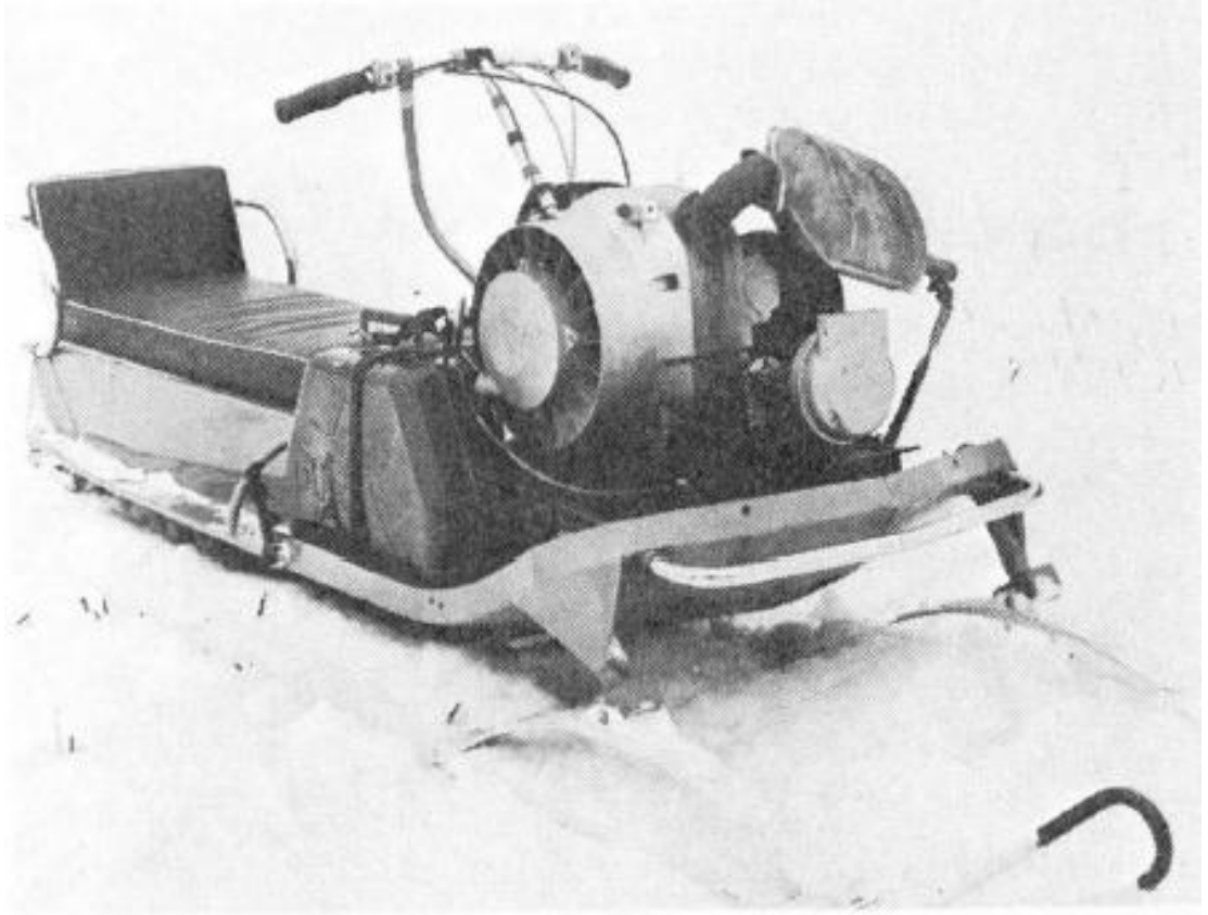
Şekil 2.16. Hava soğutmalı kızaklı kar arabası ve motoru [16].
