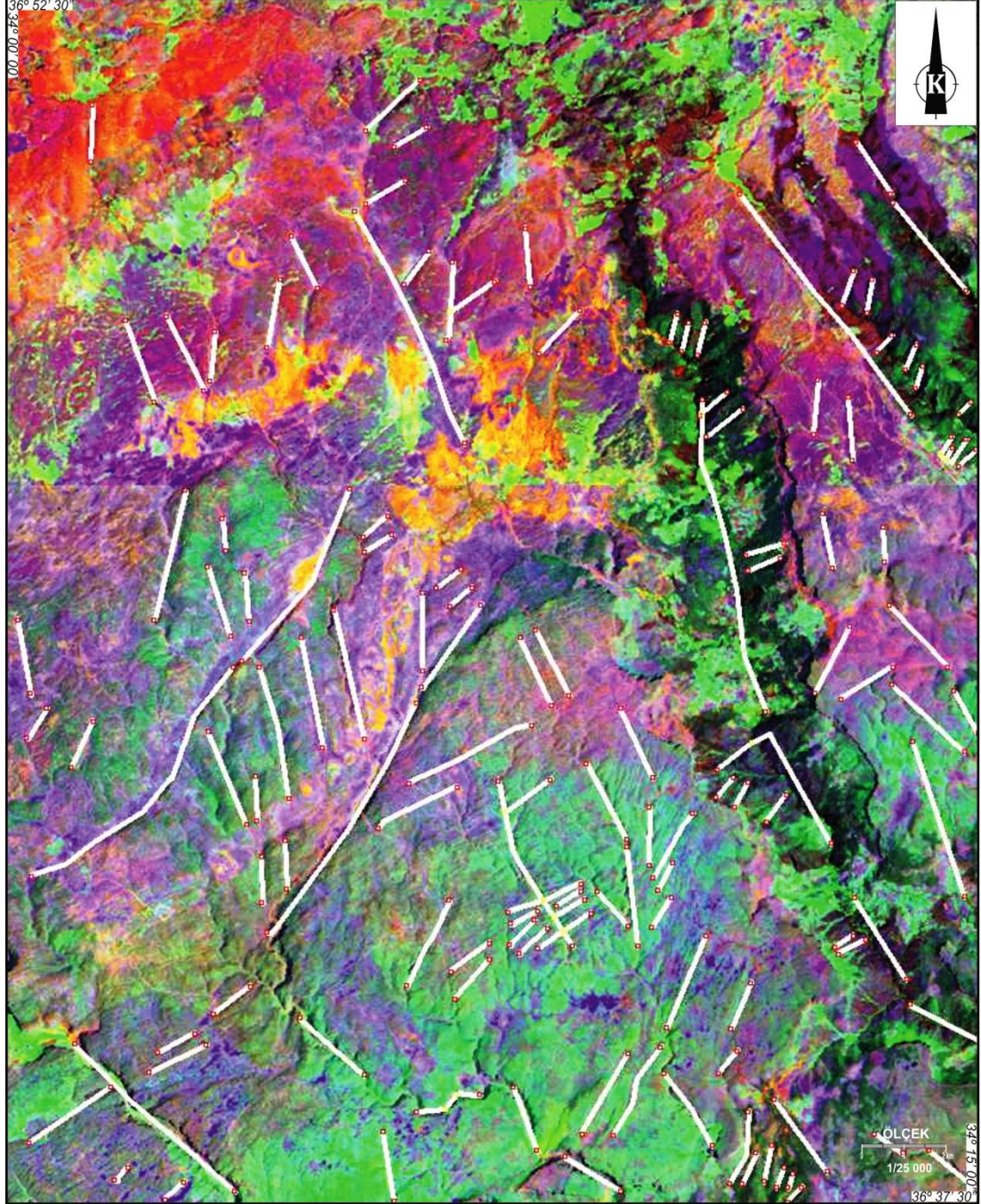
Şekil 4.50. Landsat 5 TM uydusu görüntüsü temel bileşenler analizi sonucu elde edilen RGB (PC123) kombinasyonunda belirlenen çizgiselliklerin görüntüsü.
