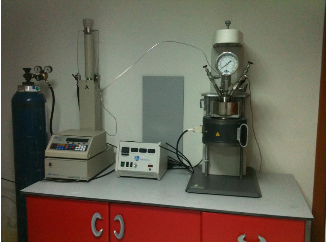
Şekil 3.4. Argon gazı tüpü; pompa sistemi; yüksek sıcaklık ve basınç reaktörü (soldan sağa)
